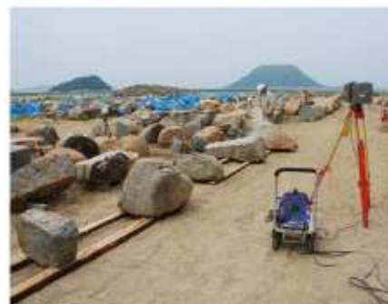
図2. 隅角部石材の背面形状計測
